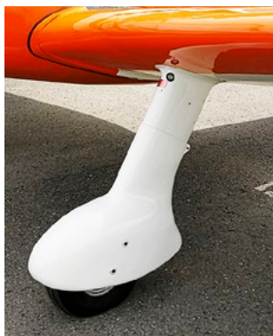
Das robuste Hauptfahrwerk steckt auch härtere Landestöße weg. Die starke Aufnahme des Spornrads nimmt über eine Zugstrebe auch Kräfte aus der F-Schlepp-Kupplung auf.
