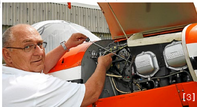
[1] Das Panel ist klassikergerecht „old fashioned“, bietet aber alles, was man zum VFR-Fliegen braucht. [2] Auf dem hinteren Sitz neben dem Tank geht es recht eng zu. [3] Mit dem Lycoming O-320 hat der Oldtimer einen „modernen“ Motor. Im Gegensatz zu vielen anderen Klassikern ist so die Ersatzteilversorgung für den Antrieb kein Problem.
