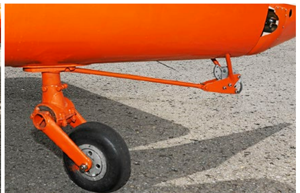
Das robuste Hauptfahrwerk steckt auch härtere Landestöße weg. Die starke Aufnahme des Spornrads nimmt über eine Zugstrebe auch Kräfte aus der F-Schlepp-Kupplung auf.
