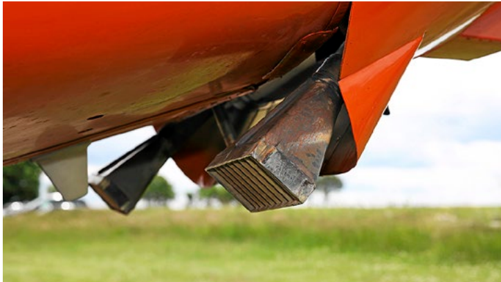
Die Liebermann-Schalldämpfer machen die Kl 107 deutlich leiser als die frühere Originalausführung der Abgasanlage.
